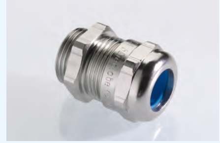
blueglobe TRI® Messing vernickelt Metrisches Gewinde EN 60423 Schutzart IP 68 bis 15 bar, IP 69K, Type 4X blueglobe TRI® Brass nickel plated Metric thread EN 60423 Type of protection IP 68 up to 15 bar, IP 69K, Type 4X
