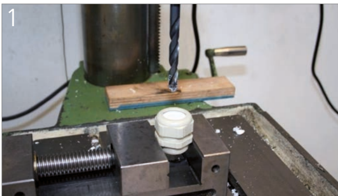
Montage des Dichteinsatzes in einem passenden Verschraubungskörper
