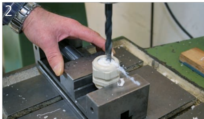
Bohrer an gewünschter Stelle positionieren. Bei geringer Drehzahl mit einem handelsüblichen HSS-Bohrer arbeiten.
