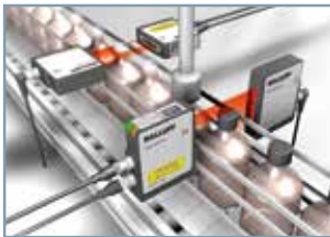
BLA-valoverho laskee kappa-lemäärät, tunnistaa komponentin ja sen asennon (max. 2 m, resol. 0,01mm)
