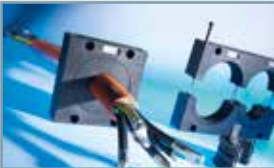
KDL Jumbo halkaistava laippa max. Ø65mm kaapeille IP65
