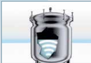
Säiliön ulkopuolelle asennettava Sonar-anturi nestepinnan korkeuden mittaukseen 30-1000 mm.
