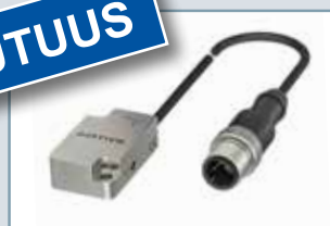
BCM condition monitoring -anturi ennakoivaan kunnonhallintaan (tärinä 3-ax, lämpötila, kosteus, paine), esim. pumput, tuulettimet, vaihteistot, laakerit.
