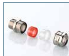
LevelEx® holkkitiivisteet ex-e ja ex-d-tilaluokkiin (IECex, EAC, DNV, CNEX, cUL, ...), M16-63 ja NPT3/8 - 2 1/2 -kierteillä
