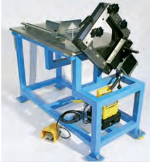
Für ein präzises Ablängen des PIK- sowie Industrie-Kanals in Stahl und Edelstahl. Bestehend aus: stabilem Maschinengrundkörper auf einstellbaren Stützfüßen oder Rollen, Aufnahme der Scherplattensätze mit teilbarem Rahmen, auf dem Grundgestell einstellbarer Längenanschlag, höhenverstellbarer Tisch, Elektrohydraulikaggregat mit Fußschalter.
