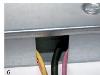
Abb. 3–6: Seitliche Ausbrüche schnell und unkompliziert mit dem Grundmodul AS Antrieb 15/300-3 und aufgestecktem Wechselwerkzeug
